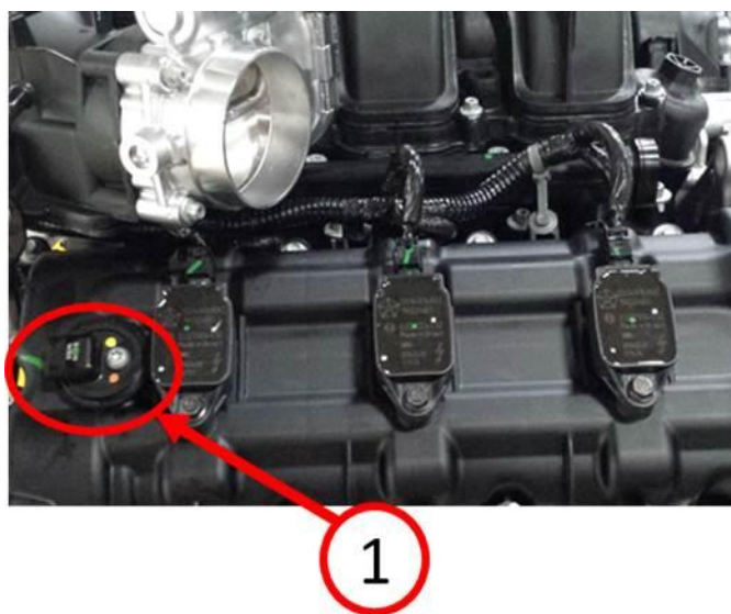
Fig. 1 Lage des Nockenwellenpositionssensors
